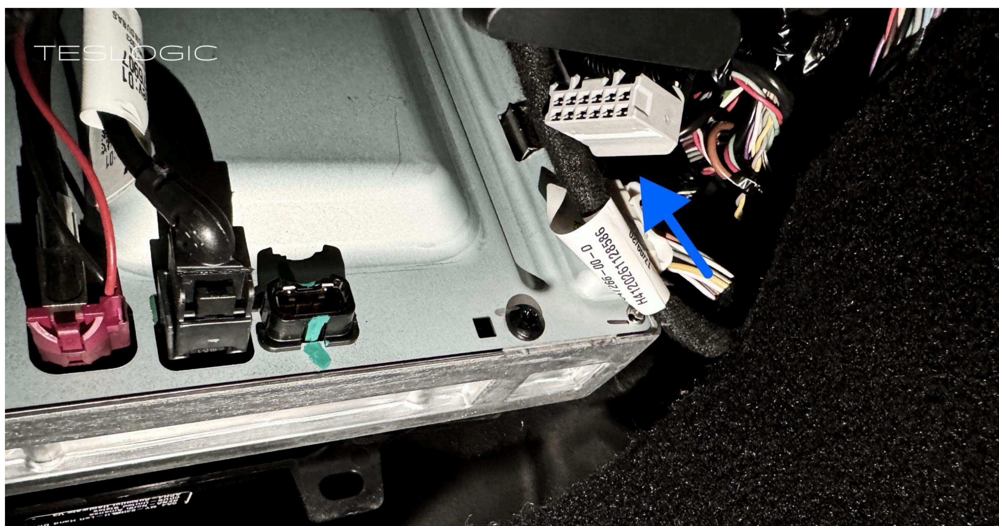
8.3 Подключите соответствующий разъем проводки Teslogic Pro к освободившемуся разъему серого цвета, а другой — к соответствующему разъему на MCU.
