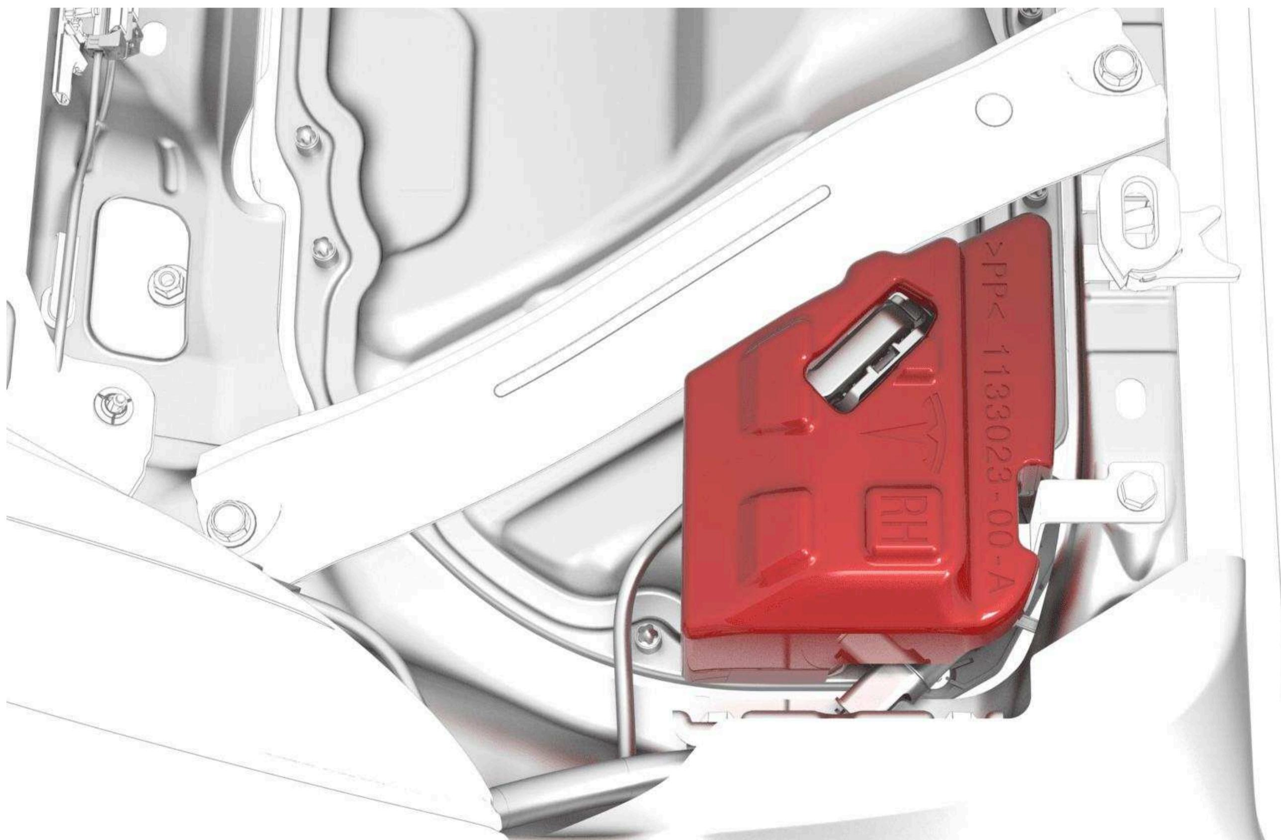
4.6 Отключите электрическую проводку от разъема контроллера высокого напряжения.
