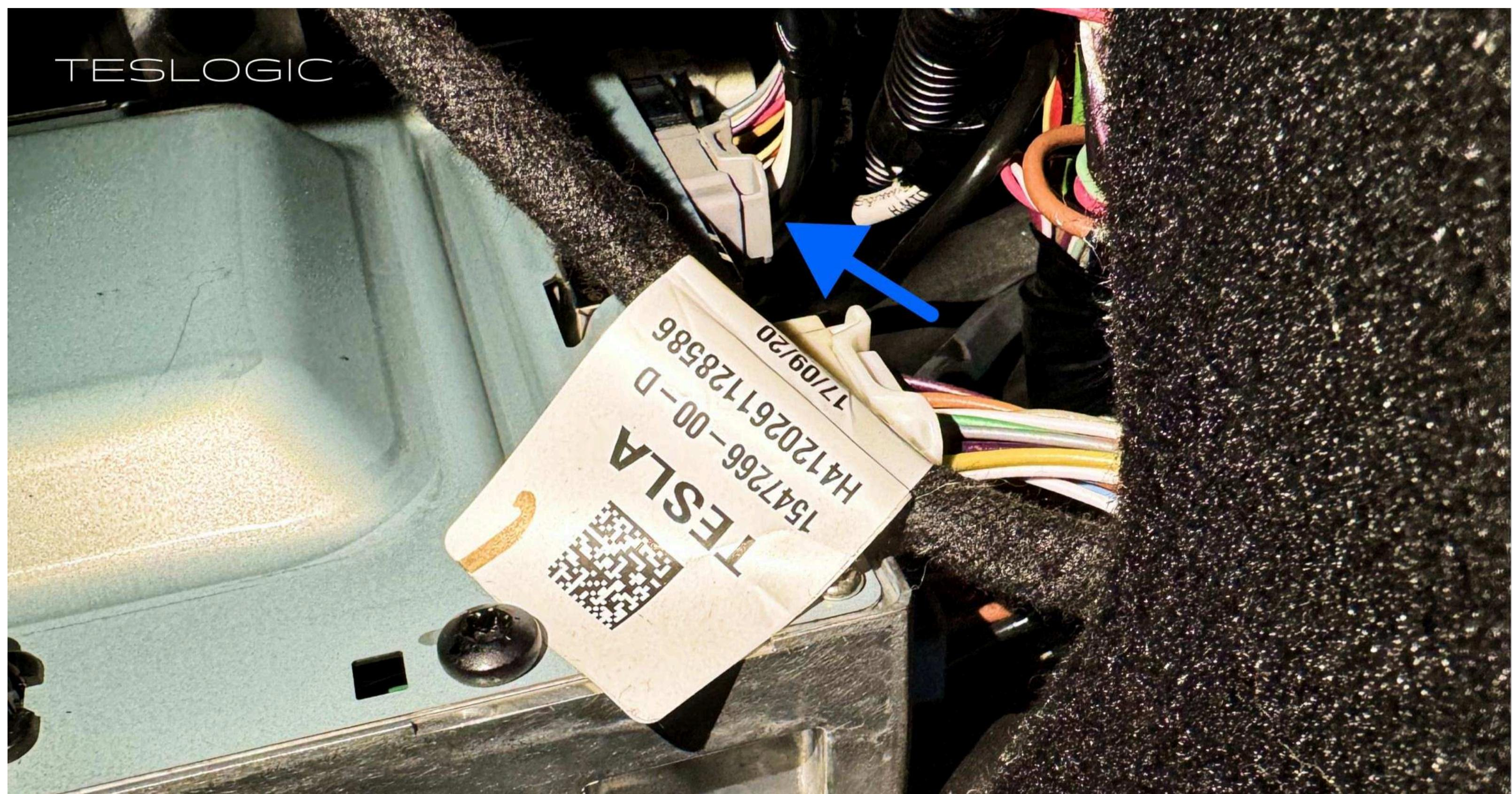
8.2 Отключите разъем. Используйте небольшой острый предмет, чтобы нажать на защелку разъема. Если вам не удается отсоединить его, вы можете снять бардачок.
