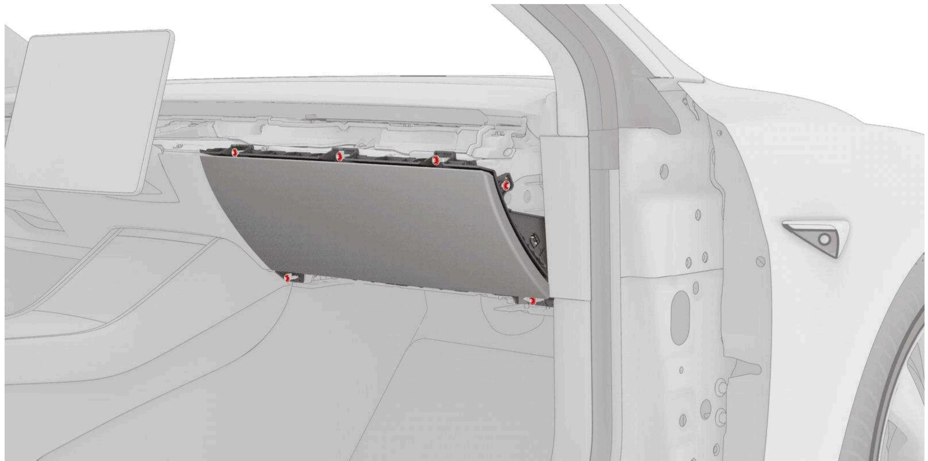
7.2 Отключите электрическую проводку от разъема соленоида бардачка, разъема заслонки/амортизатора и разъема подсветки порогов.
