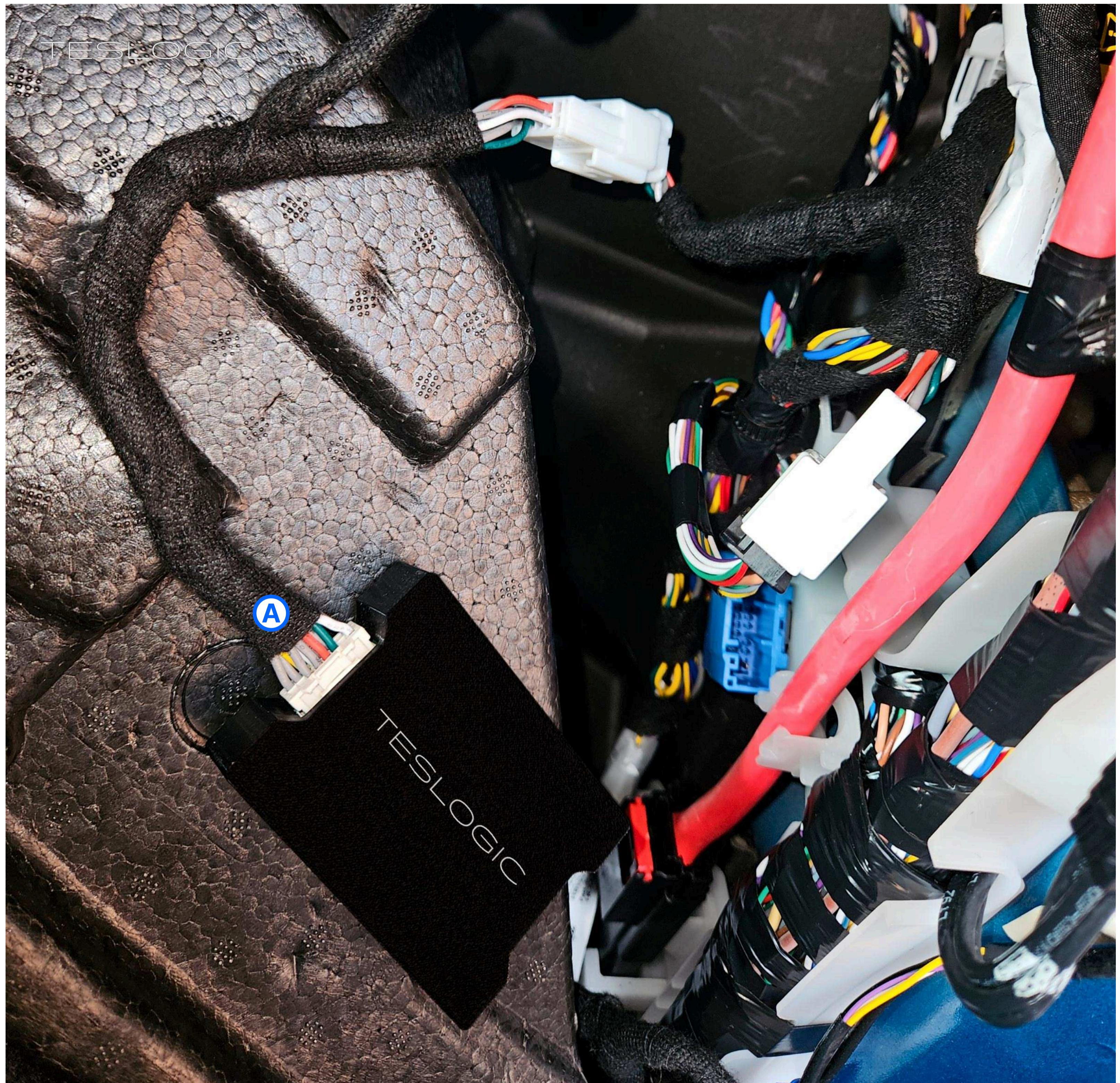
9.5 Установите устройство Teslogic Про в углубление внизу.
