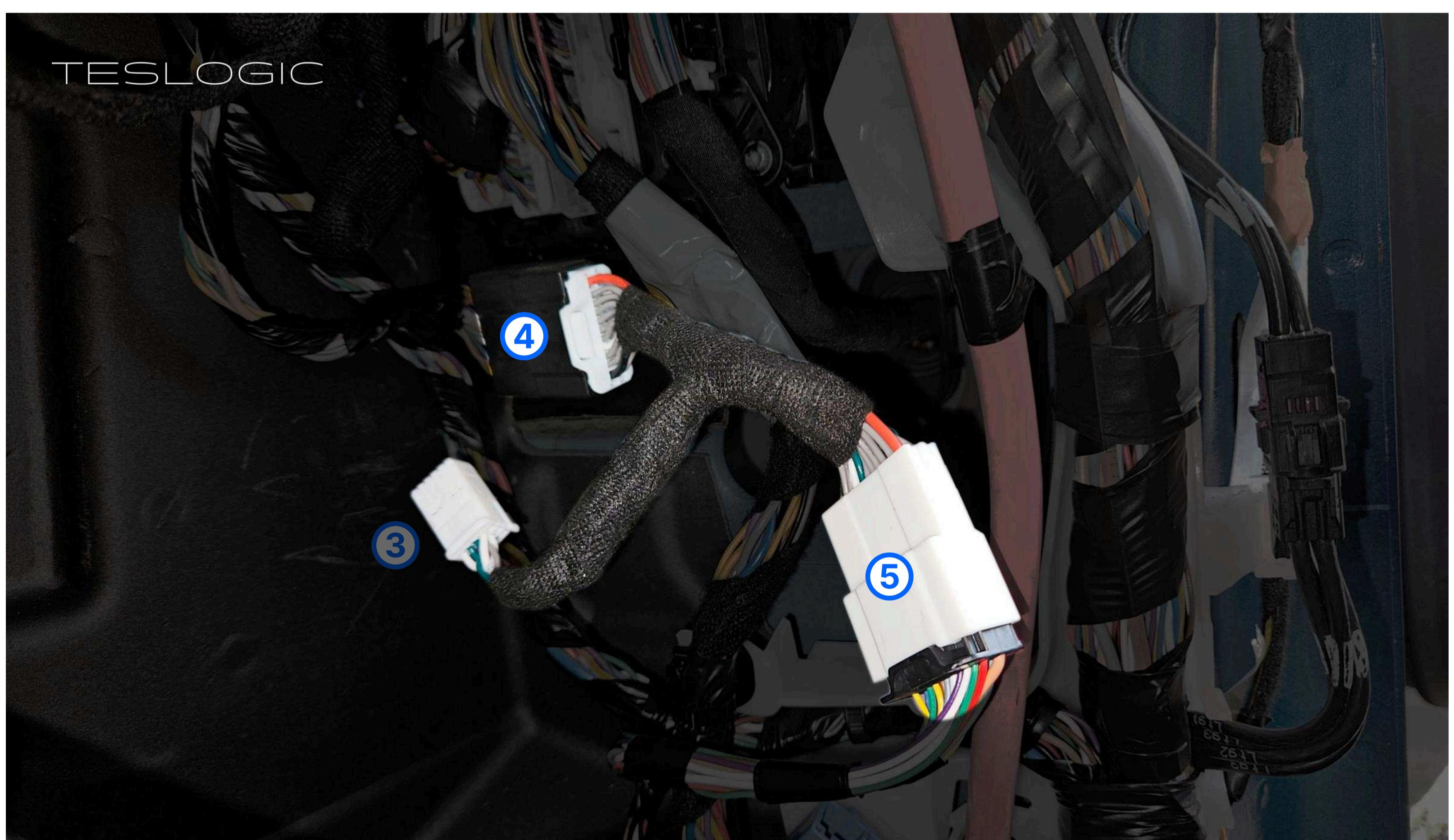
9.2 Отсоедините штекер от верхнего разъема, подключите его к длинной проводке, а затем подключите длинную проводку к верхнему разъему.
