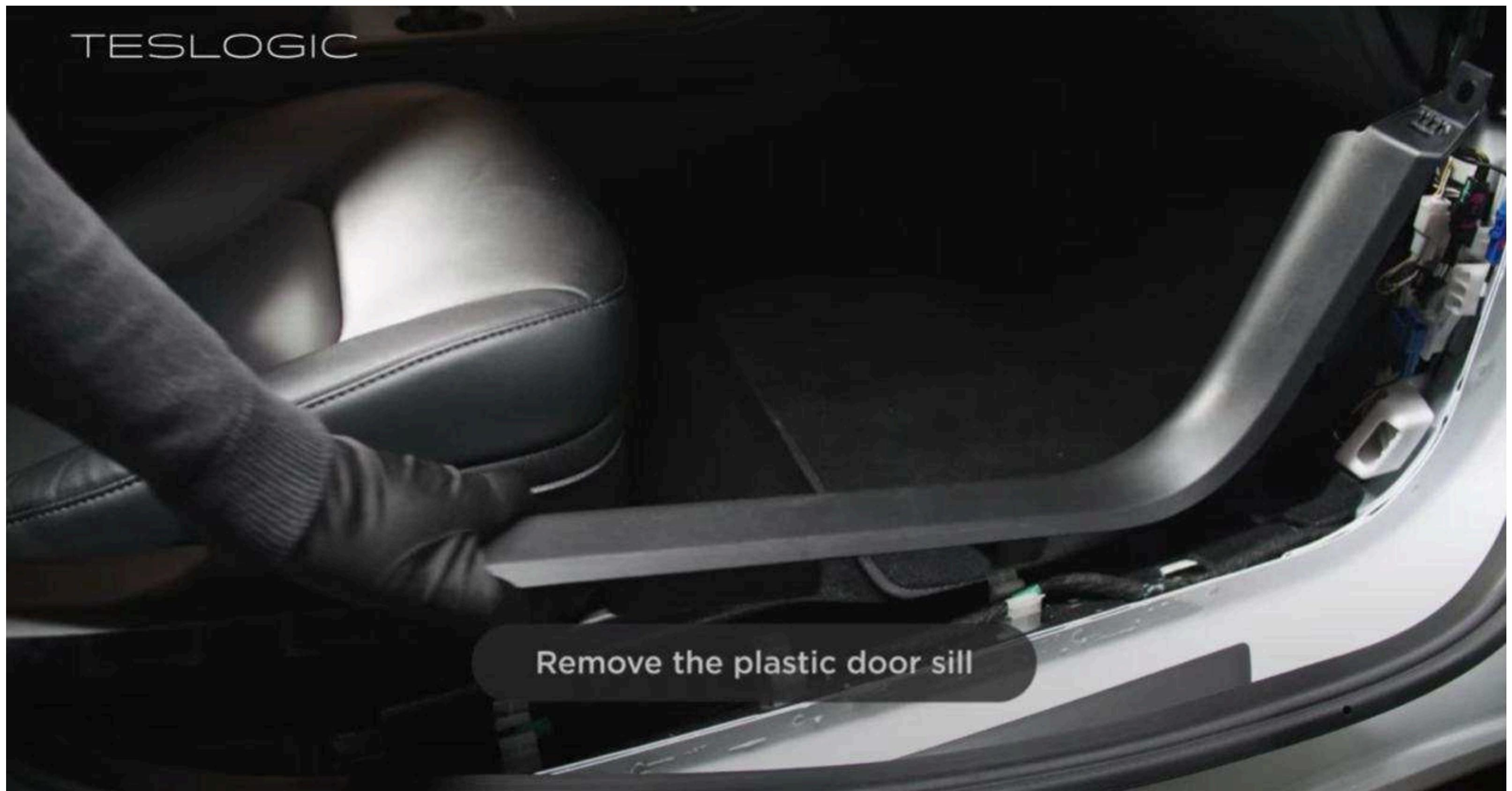
5.5 Снятие нижней пластиковой крышки для Модели 3.
