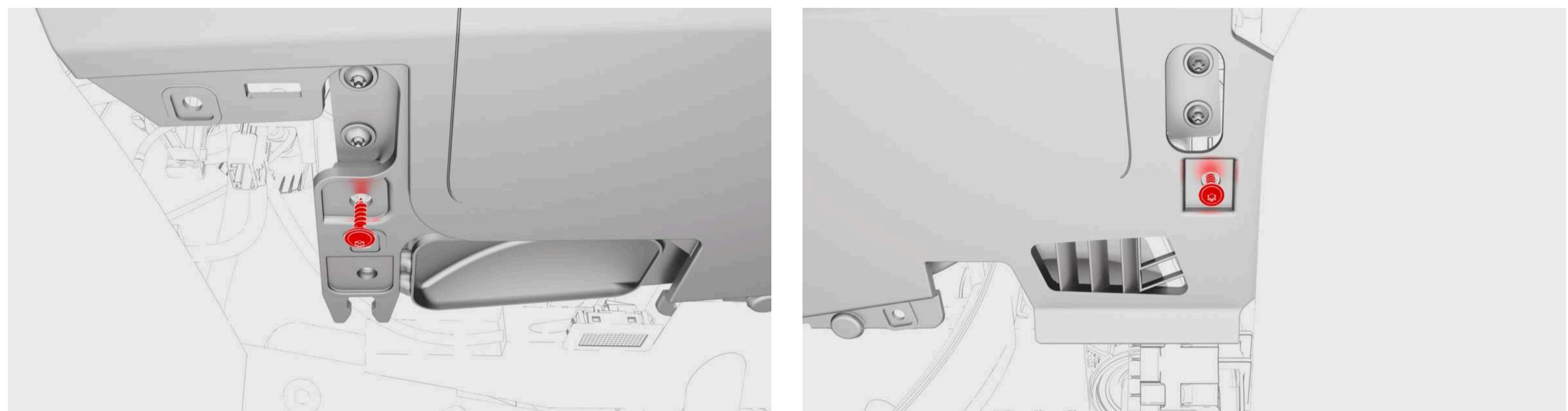
6.2 Поддерживая подушку безопасности переднего пассажира, снимите и утилизируйте болты (x4), крепящие подушку безопасности переднего пассажира к приборной панели.
